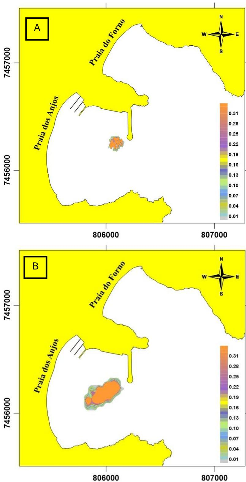
Figura 65 A e B: Modelo determinístico para vazamento de óleo (50 m<sup>3</sup>) com ventos do quadrante N-E. Na figura 61B, observa-se a forte influência do vento no deslocamento da mancha após 30 minutos.
