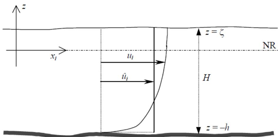
Figura 21: Esquema de coordenadas para os modelos 3D e 2DH, onde NR é o Nível de Referência. No caso 2DH,  $\hat{u}_i$ , representa a velocidade promediada na vertical. A profundidade instantânea  $H = z \text{ sup.} - z \text{ fundo} = \zeta + h$ , também é chamada de altura da coluna de água. (ROSMAN, 2014).
