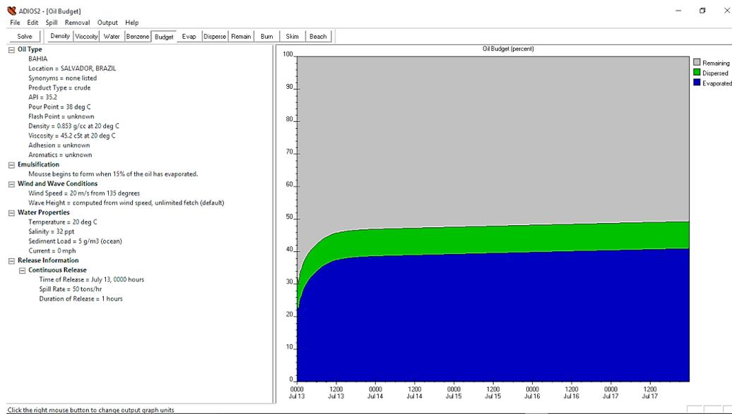
Figura 53: O gráfico apresenta em azul a quantidade evaporada, em verde, a quantidade dispersada e em cinza a quantidade remanescente do total simulado que são 50 m<sup>3</sup> de hidrocarboneto. Principais características: °API = 35,2, gravidade específica = 0,851 kg/m<sup>3</sup> a 22 °C, viscosidade = 40 cSt a 22 °C e ponto de fluidez = 38 °C (ADIOS2, 2016).
