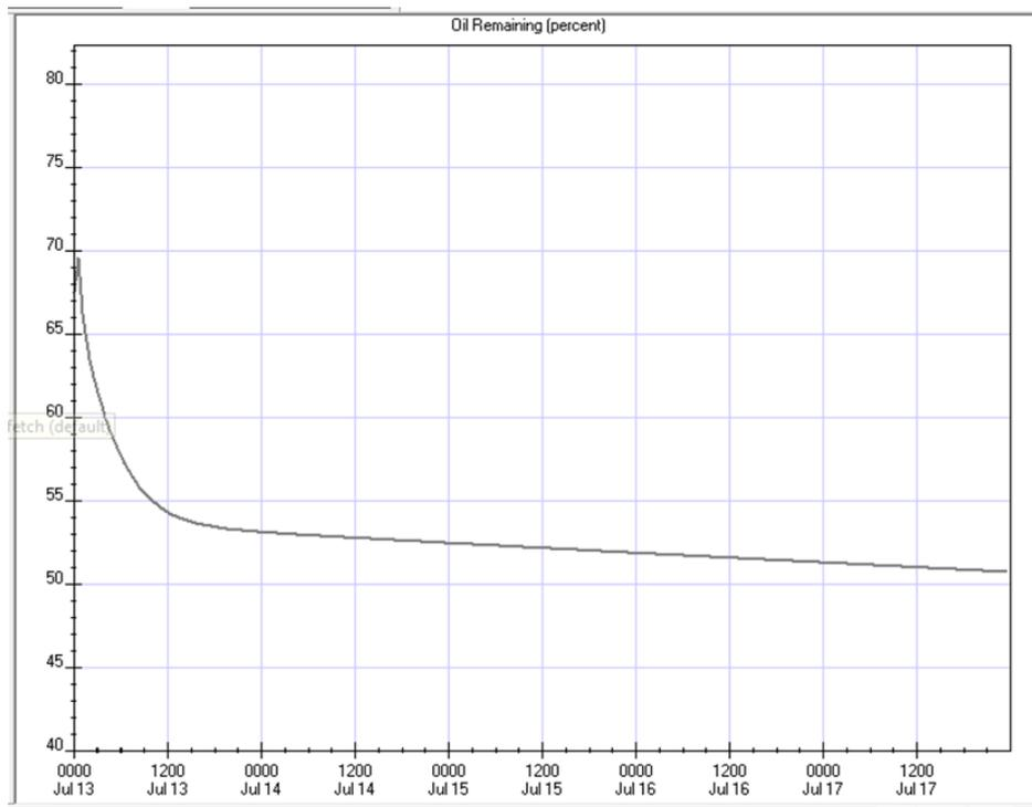
Figura 54: A curva de decaimento do óleo, obtida pelo programa ADIOS, apresenta que o volume remanescente em questão, após de 5 dias, é pouco mais de 50% do total, isto é, em torno de 25 m<sup>3</sup>. Utilizada para a curva de decaimento do óleo inserida no SisBaHiA® (ADIOS, 2016).
