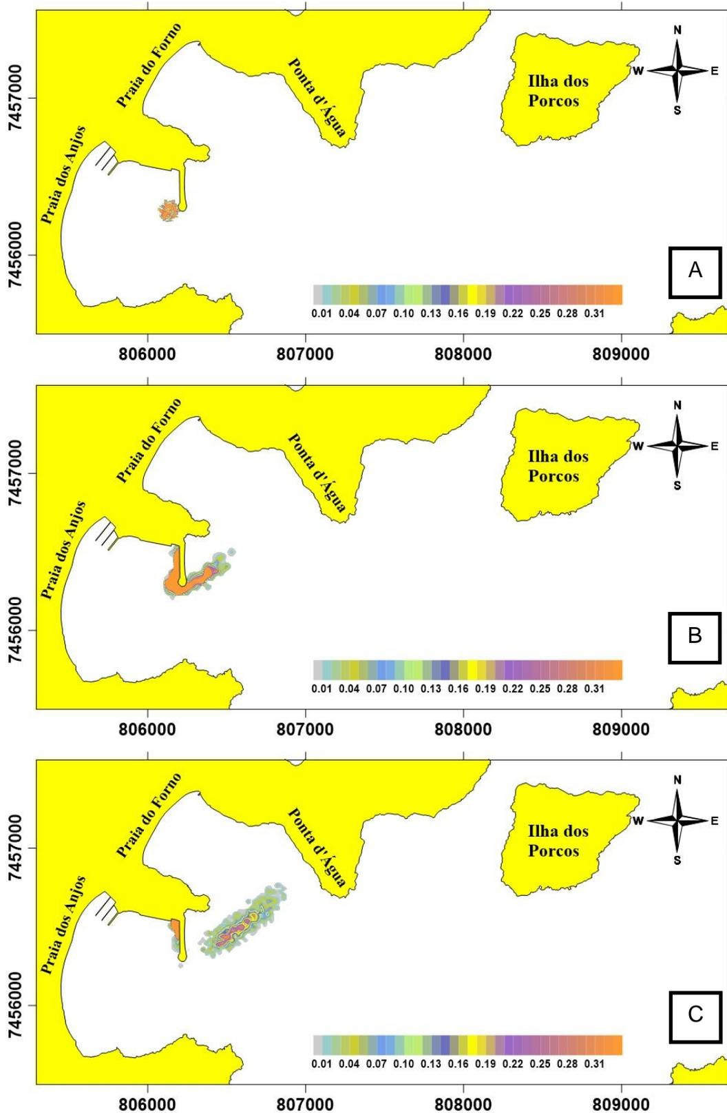
Figura 61: Na parte superior, instante inicial do vazamento. Na figura 57B, após 30 minutos do instante inicial do derrame, a mancha contorna o quebra-mar. Após 1 hora se dirige para a Ponta d'Água (figura 57C).
