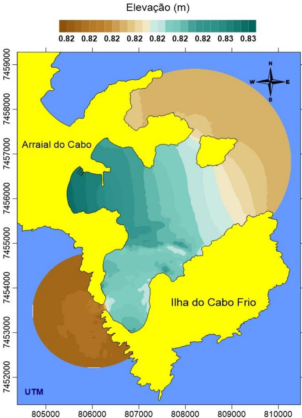
Figura 49: Elevação da superfície livre para o instante  $t = 3.913.200$  s, 02/09/99, às 07:30h. Preamar de quadratura. Observa-se na parte SW do Boqueirão Sul elevação de 0,815m, aumentando para 0.825 nas proximidades da Enseada dos Anjos. Volta a reduzir atingindo cerca de 0,819m na parte NE do domínio.
