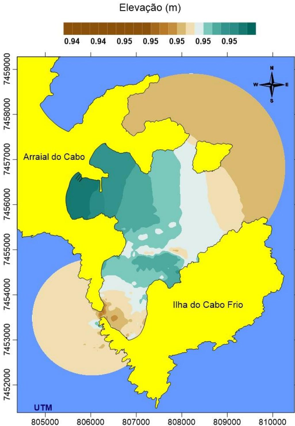
Figura 45: Elevação da superfície livre para o instante  $t = 1.405.800$  s, 04/08/99, às 07:00h. Preamar de sizígia. Observa-se nos extremos do mapa valores menores para a elevação, em torno de 0,946 m. O local com a maior elevação é a na Enseada dos Anjos  $\sim 0,953$  m. A parte interna das EAC apresentam valores intermediários.
