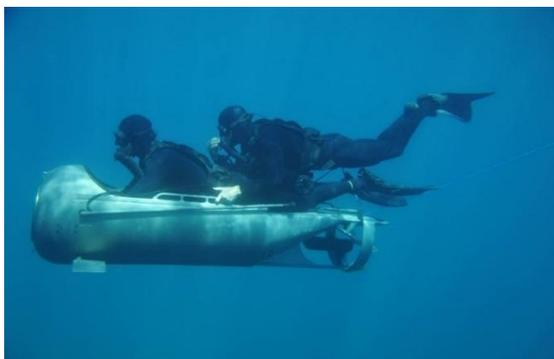
FIGURA 10: Procedimento de infiltração submarina de uma dupla MEC a partir de um DPV modelo STIDD DPD. (Fonte: Disponível em <<http://www.betasom.it/forum/index.php?showtopic=11826&page=2>>. Acesso em: 25 nov. 2015.).
