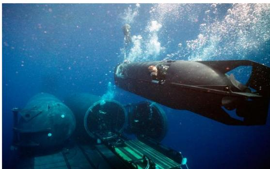
FIGURA 8: Manobra de aproximação de um SDV MK VIII Mod-1 visando a atracagem em um dos casulos DDS posicionados no casco do submarino USS Kamehameha (SSN 642). (Fonte: Disponível em <[http://www.militaryfactory.com/imageviewer/shp/pic-detail.asp?ship\\_id=SEAL-Delivery-Vehicle - SDV&sCurrentPic=pic6](http://www.militaryfactory.com/imageviewer/shp/pic-detail.asp?ship_id=SEAL-Delivery-Vehicle-SDV&sCurrentPic=pic6)>. Acesso em: 22 nov. 2015.).
