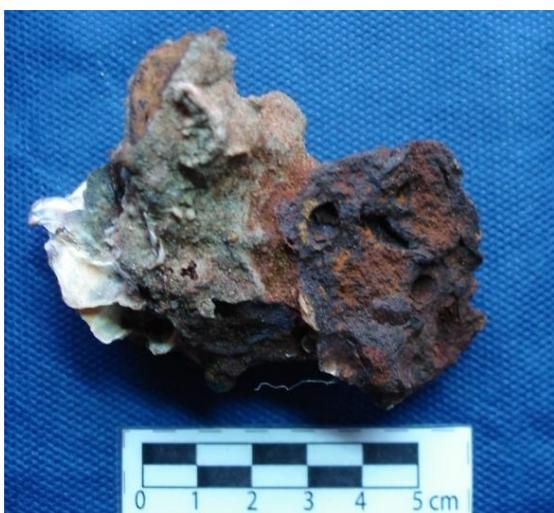
Imagem 106 – Aspecto de amostra da concreção após ser retirada da solução de H<sub>2</sub>O<sub>2</sub> (10%)
