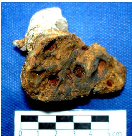
Imagem 105 – Aspecto de amostra da concreção após ser retirada da solução de HCl (10%)
