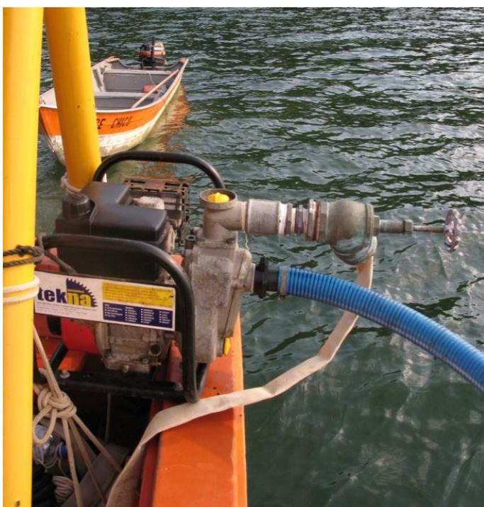
Imagem 73 - Moto-bomba acoplada à embarcação. Foto: Alvanir
