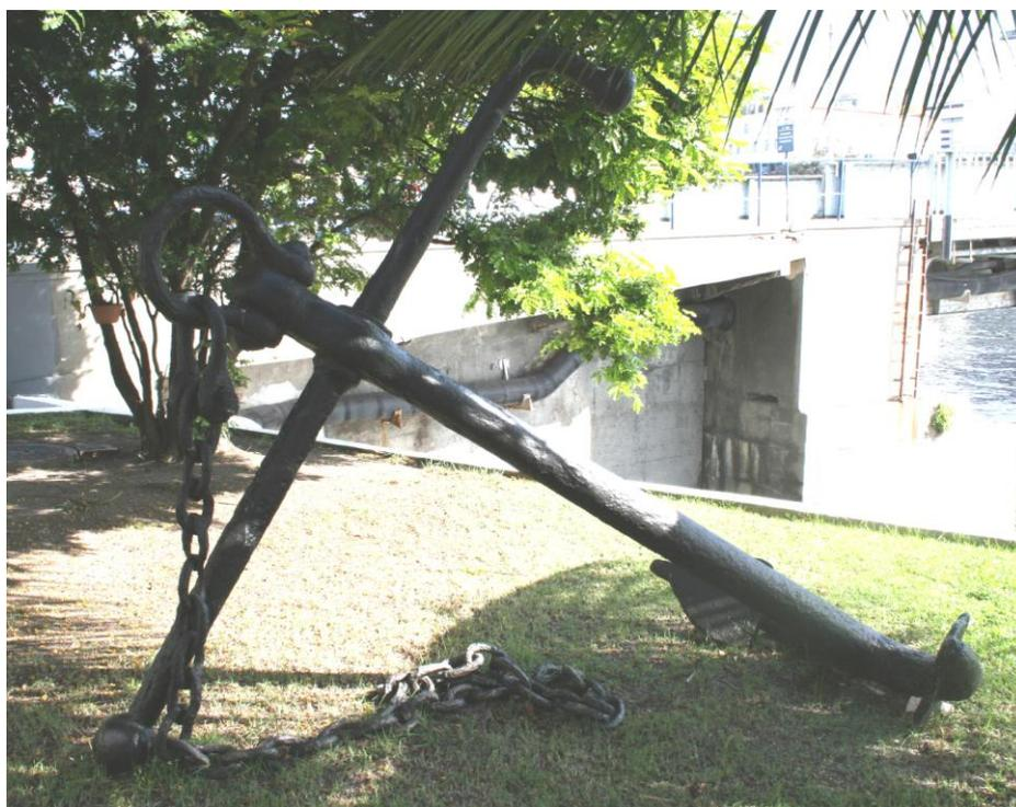
Imagem 132 - Modelo âncora tipo Almirantado (braços, haste e cepo retrátil de ferro)
