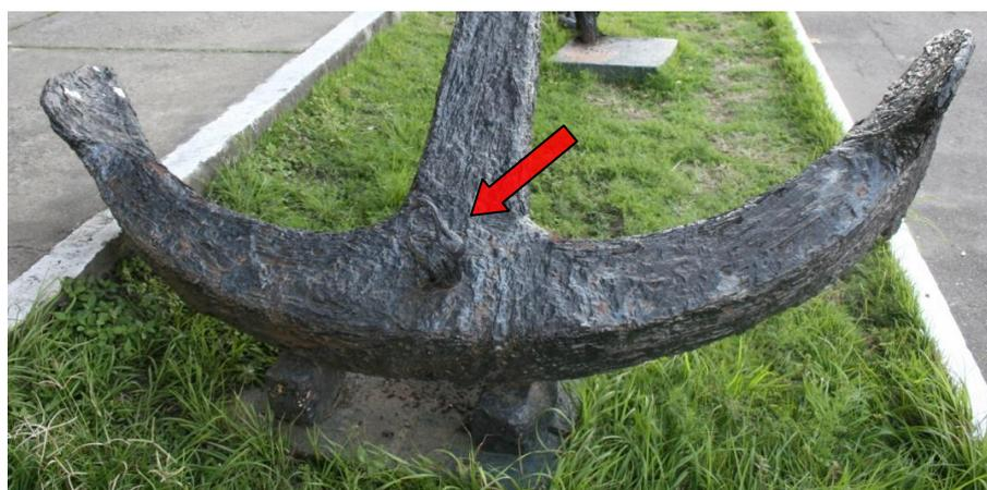
Imagem 137 - Detalhe da argola destinada ao cabo do arinque
