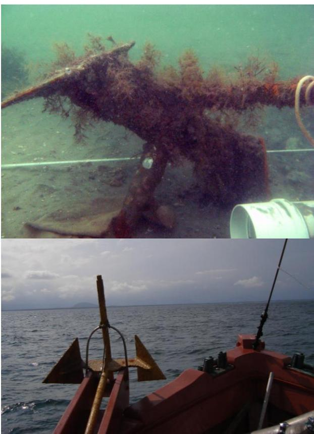
Imagem 70 - Visão da âncora tipo Patente (II) garrada ao fundo da enseada. Na imagem logo abaixo pode-se observar modelo idêntico preso na proa da embarcação de pesquisa *Albacora*
