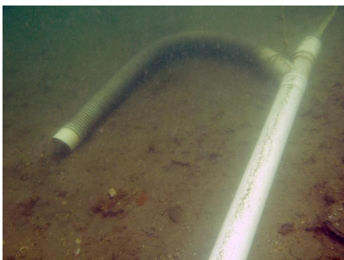
Imagem 74 - Conexão em “Y” da sugadora
