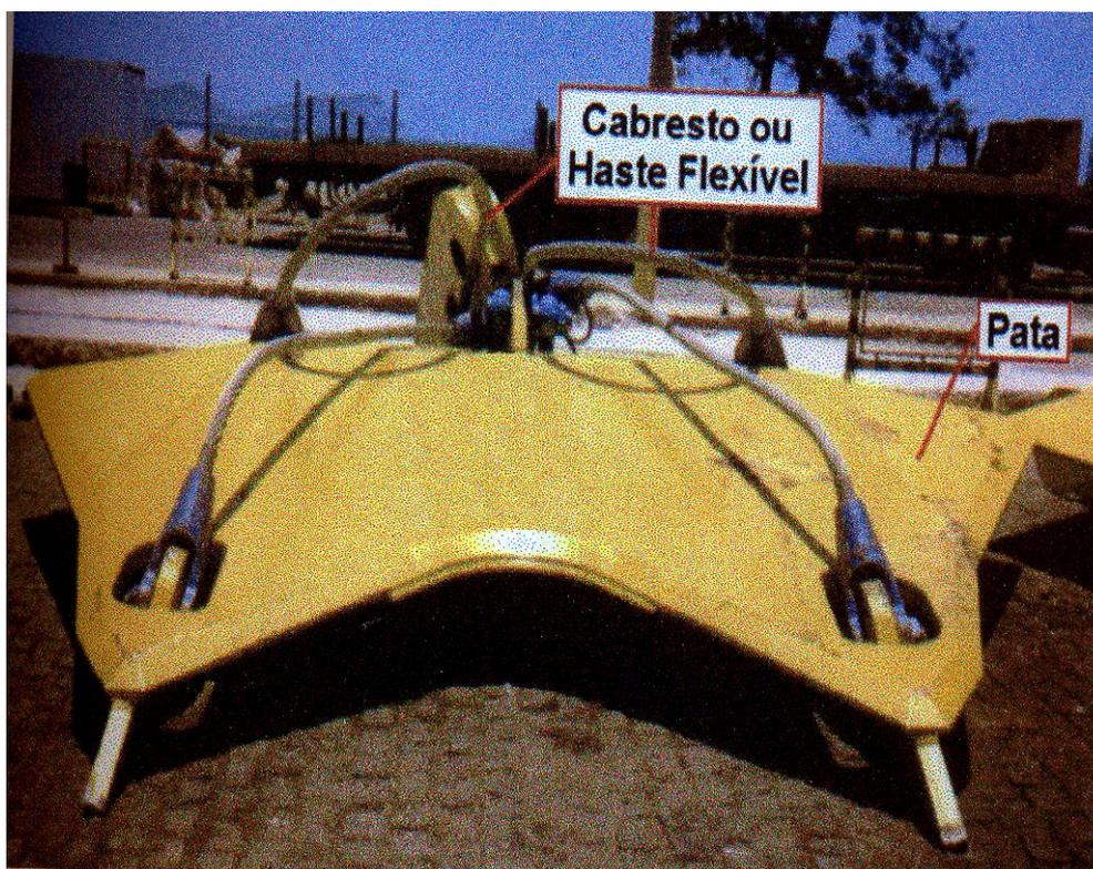
Imagem 156 - Modelo de uma âncora oceânica STEVMANTA de 13m<sup>2</sup>
