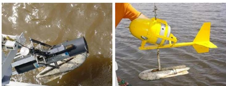
Fotografias 3.12; e 3.13 - Equipamentos usados na coleta d'água
