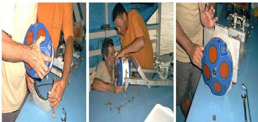
Fotografias 3.2; 3.3 e 3.4 - montagem do ADCP na embarcação de apoio
