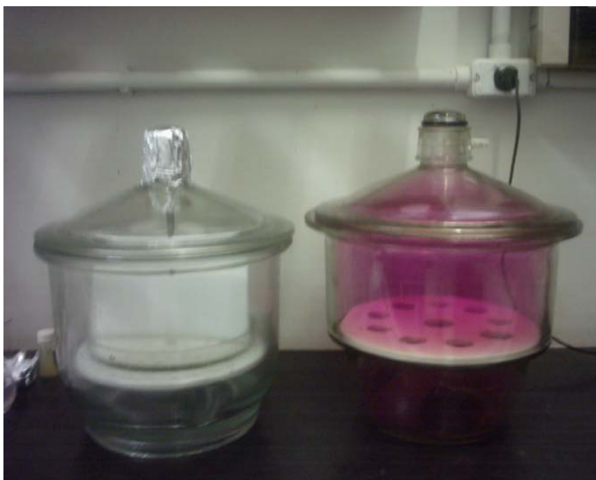
Figura 69. Cuba para corrida cromatográfica (TLC) e câmara de iodo para revelação da placa.
