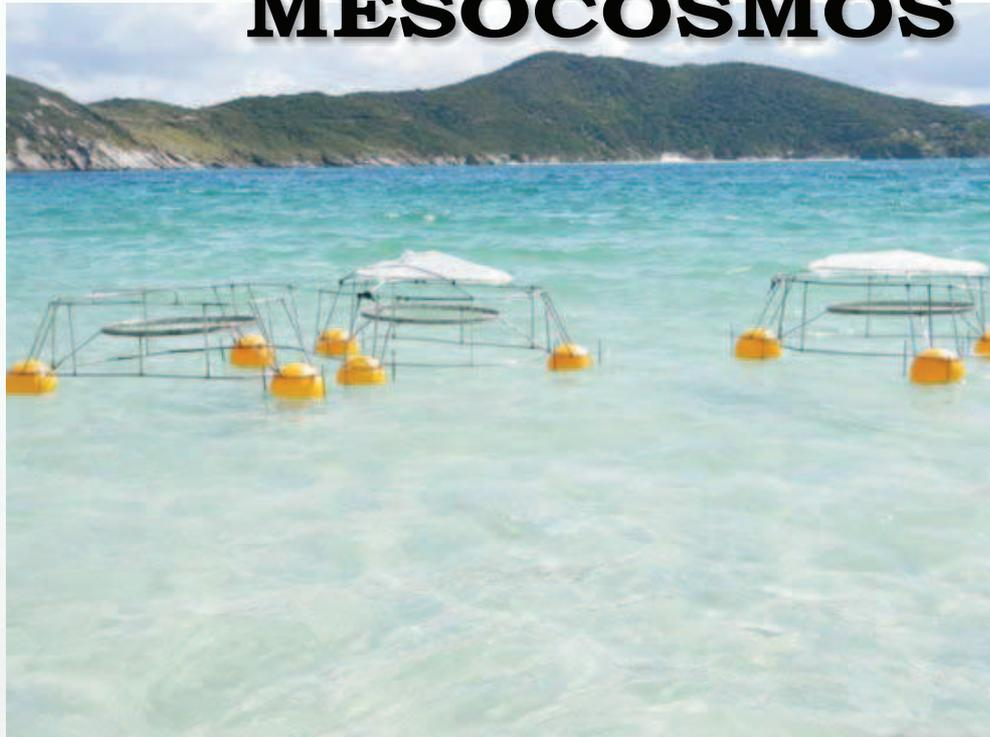
Figura 1: Testes preliminares de flutuabilidade dos mesocosmos no Campo de Testes do IEAPM.
