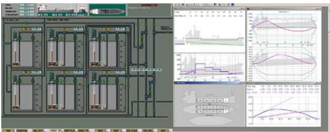
O LCHS (Liquid Cargo Handling Simulator) permite a simulação de carga e descarga de uma embarcação de graneis líquidos, podendo gerar situações críticas nesta faina fazendo com que os oficiais envolvidos neste trabalho possam responder de forma correta e rápida a qualquer situação crítica. Este simulador também utiliza o programa LoadCalculator, que faz cálculos necessários, como carregamento do navio, estabilidade e esforço.
