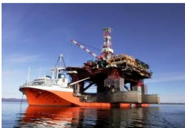
Figura 04 - Navio transportando uma plataforma
