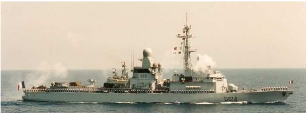
Figura 2: A fragata francesa *Casard* (foto acima) e suas irmãs estão entre as maiores escoltas construídas, propulsionadas somente por motores diesel.
