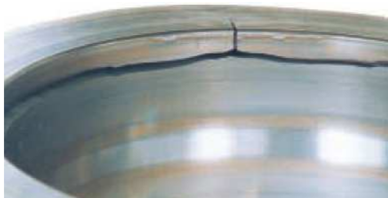
Figura 9: Anel externo do rolamento com trinca
