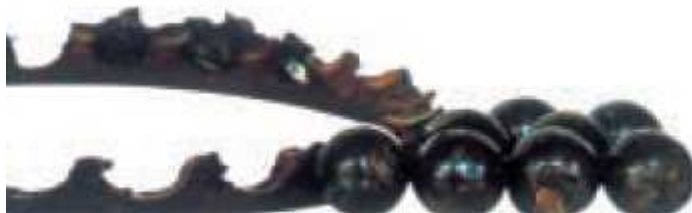
Figura 12 :Gaiola totalmente rompida
