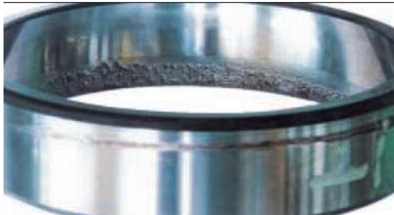
Figura 8: Anel externo danificada
