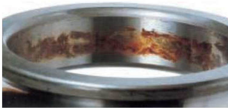
Figura 7: Anel interno do rolamento com corrosão
