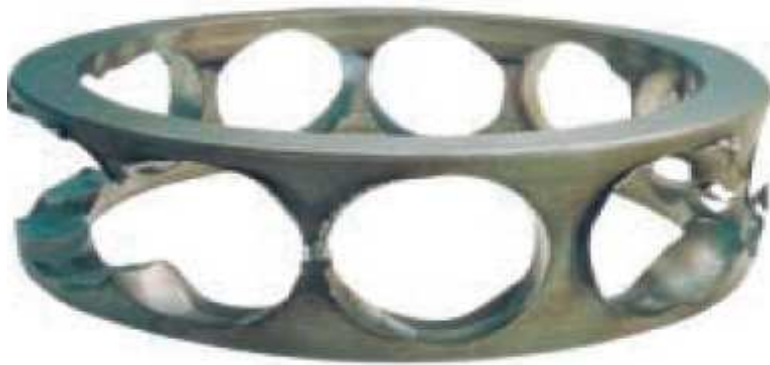
Figura 11: Gaiola do rolamento com rupturas
