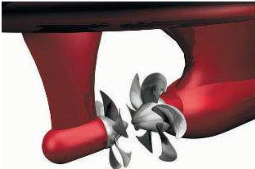
Fig. 12. Imagem do CRP AZIPOD®
