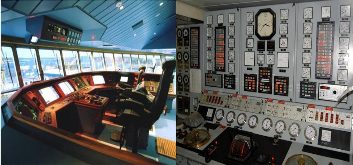
Figura 3 – A esquerda o Passadiço e a direita o Centro de Controle de Máquinas (CCM)
