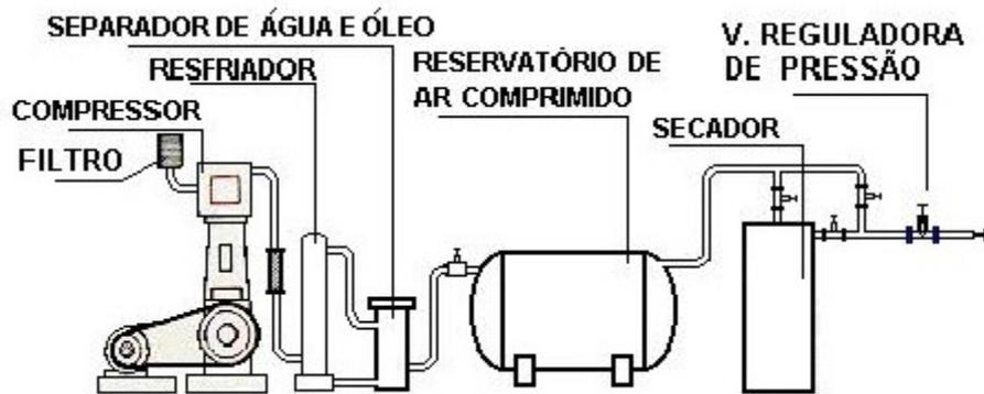
Figura 2 - Esquema simples do sistema de produção e tratamento de ar comprimido. (Fonte: BRASIL. Diretoria de Portos e Costas. Ensino Profissional Marítimo. **Princípios de Automatização de Processos; Princípios de Automatização de Comandos**. Rio de Janeiro: 1995. p. irreg. Curso de Aperfeiçoamento Vol.6.).
