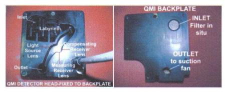
Figura 19 - Pontos a ser realizada a manutenção (limpeza, troca do filtro de bronze)
