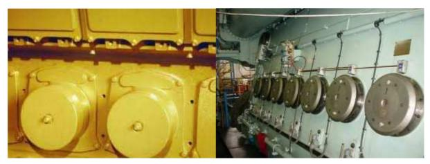
Figura 5 - Válvulas de segurança do cárter de motores diesel marítimos
