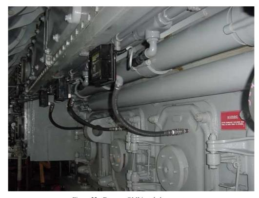
Figura 22 - Detector QMI instalado no motor
