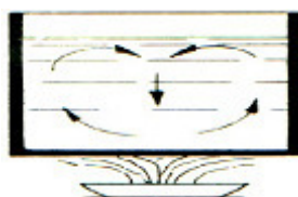
Figura 5: Exemplo de transmissão por convecção.
