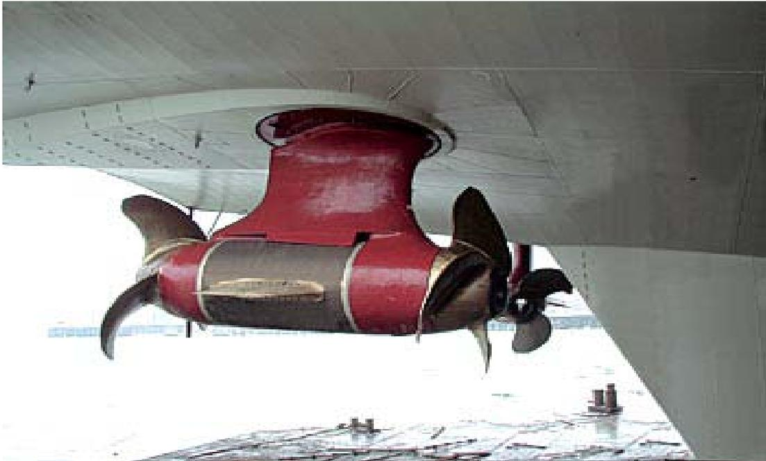
**Fig. 8:** Exemplo de Twin Propeller.
