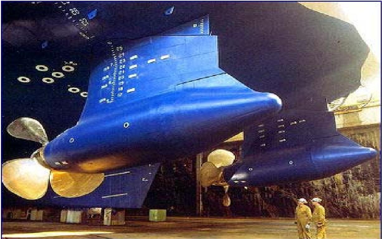
**Fig. 7:** Vista da popa de uma embarcação de apoio com dois propulsores tipo Azipods.
