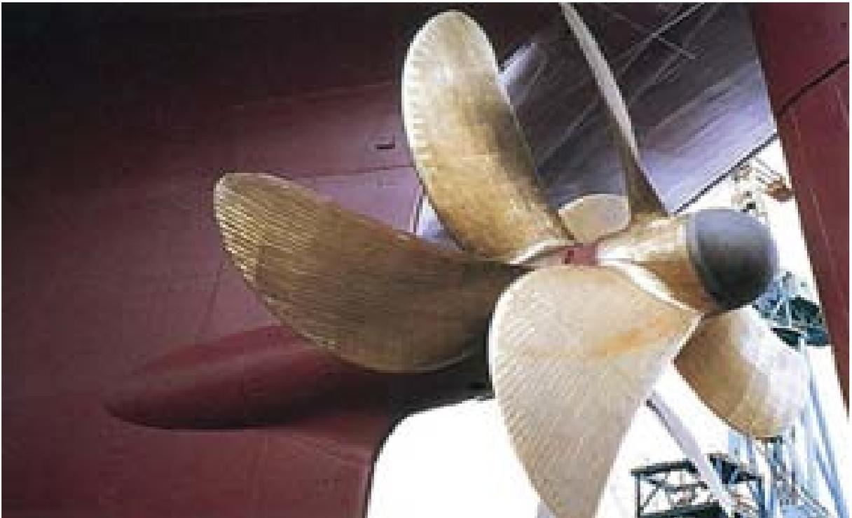
**Fig. 9:** Exemplo de CRP Hélices Contra rotativas.
