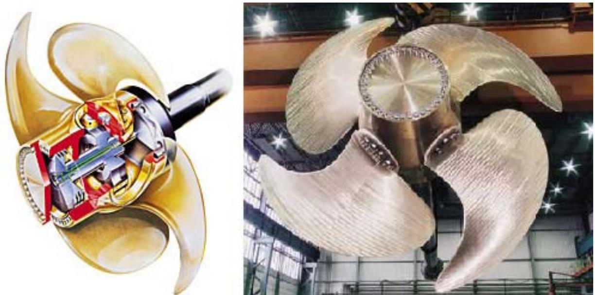
**Fig. 6:** Exemplo de propulsor de passo controlável
