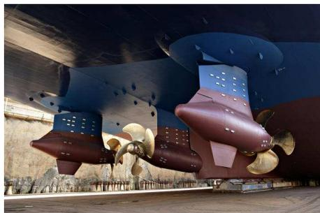
*Fig. 1 - Motor de propulsão*
