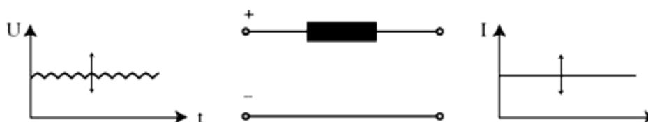
Figura 28 - Inversor fonte de corrente
