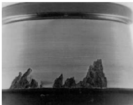
Figura 11 - Mancal danificado por desalinhamento
