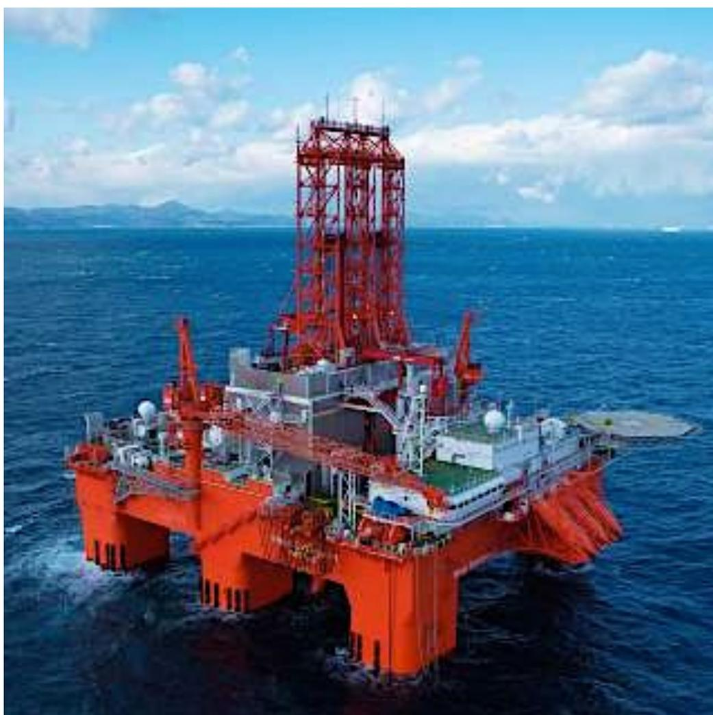
Figura 14 - Sonda West Eminence tipo Ram Rig com Torre Dupla
