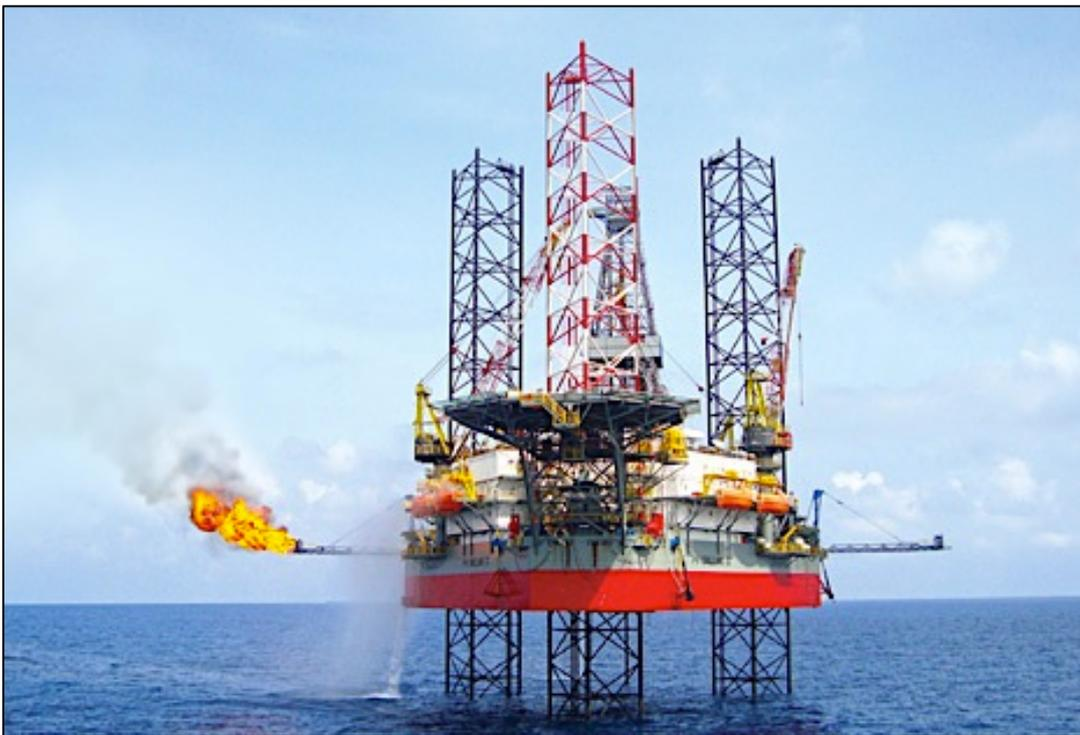
Figura 32 – Jack Up (Fonte: Seadrill)
