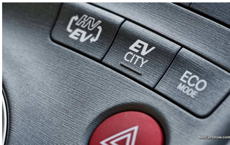
Figura 3 - Modos de operação de um modelo Híbrido: Modo híbrido ( Hybrid Mode ), o qual utiliza normalmente o motor à combustão junto com o elétrico, Modo Elétrico ( Electric Mode ), e modo econômico ( ECO Mode ), no qual o motor a combustão trabalha juntamente com o elétrico, porém com uma menor participação com o objetivo de se economizar combustível).
