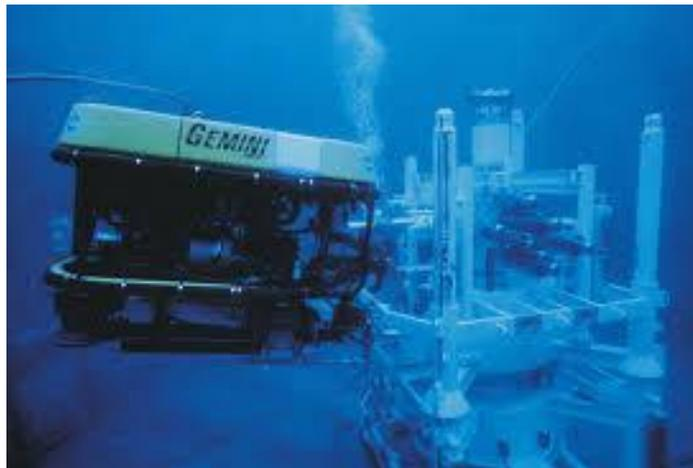
Figura 19 – Inspeção da Árvore de Natal
