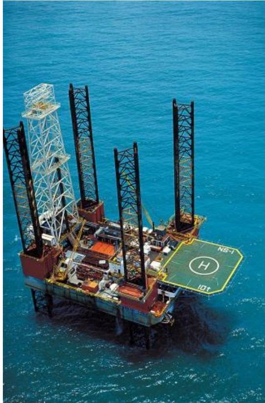
Figura 8 – Plataforma Autoelevável.
