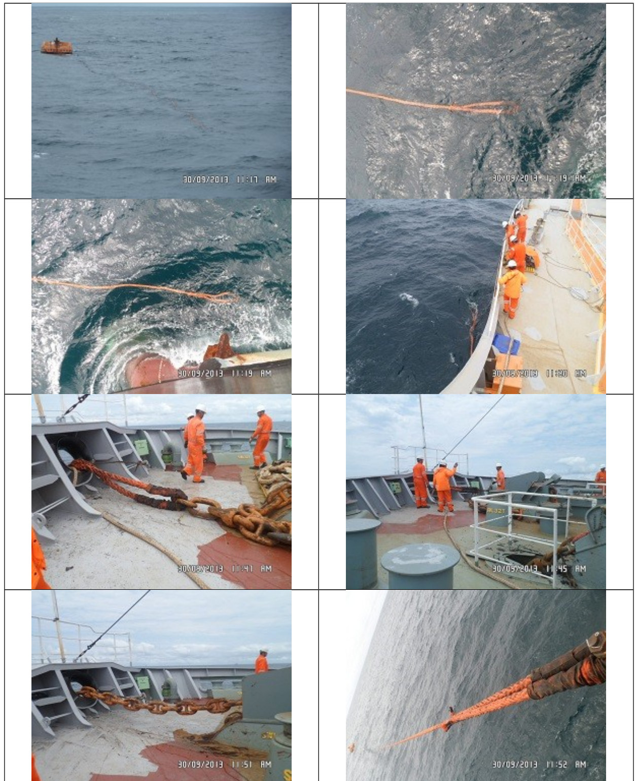
Figura 4 - Sequência de fotos da manobra de amarração
