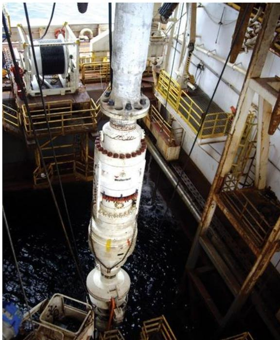
**Figura 10 - Modelo 7875. O anel de tensão, que é uma parte muito importante para a planta do MPD.**
