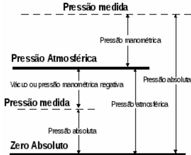
Figura 4 – Referenciais para medição de pressão
