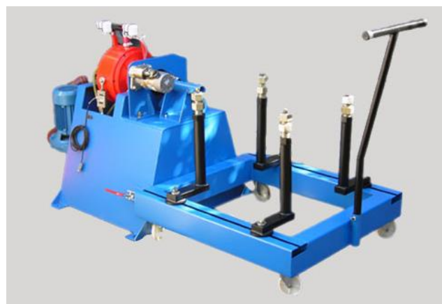
Figura 3.2 - Mostrando um dinamômetro hidráulico
