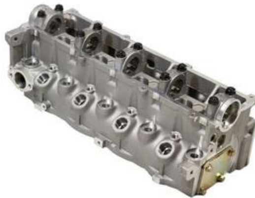
Figura 1.3 - Cabeçote do motor diesel 2.0 do GM-TRACKER
