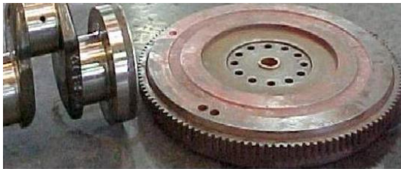
Figura 1.9 - Volante desacoplado do eixo de manivelas.
