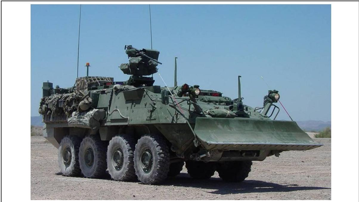
FIGURA 5 - *Obstacle Clearance Blade* instalado em uma viatura blindada Piranha
