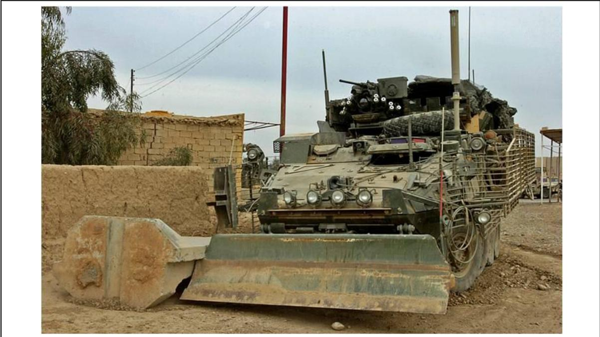
FIGURA 7 - *Obstacle Clearance Blade* transpondo um obstáculo
