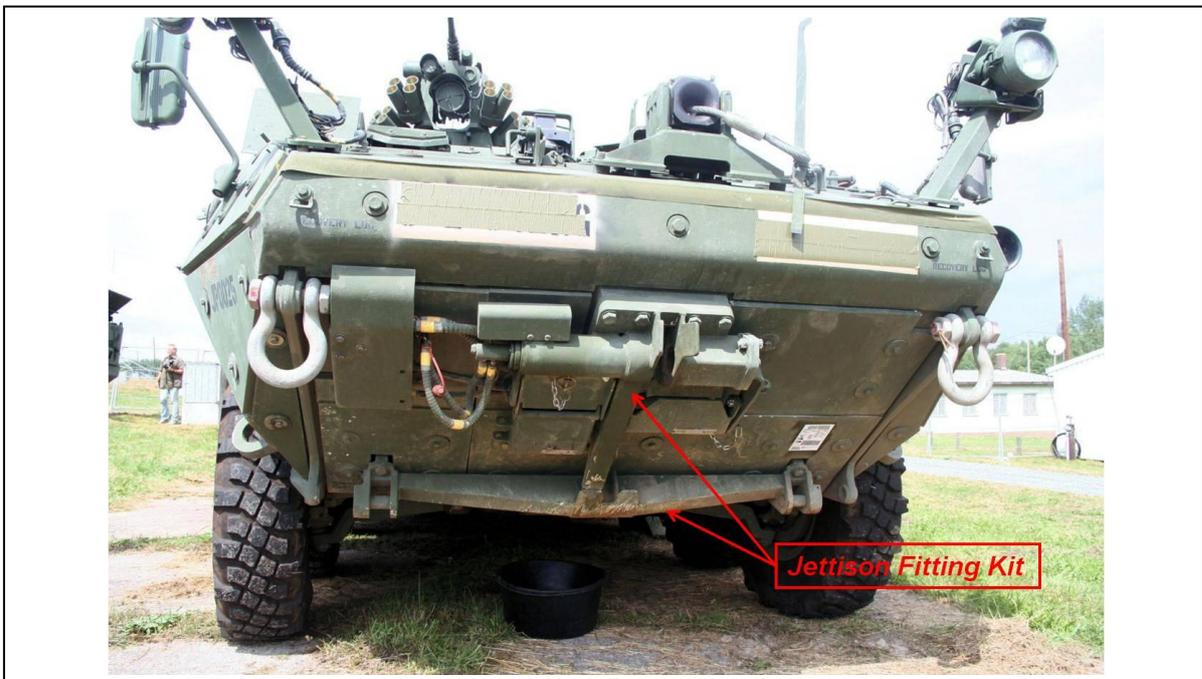
FIGURA 8 - *Jettison Fitting Kit* instalado em uma viatura blindada
