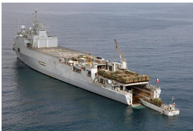
FIGURA 1 – Navio-Doca Multipropósito Classe “FOUDRE”. Observa-se operando com sua potencialidade para transporte de cargas e viaturas, convés para operações aéreas e docagem de embarcações miúdas.
