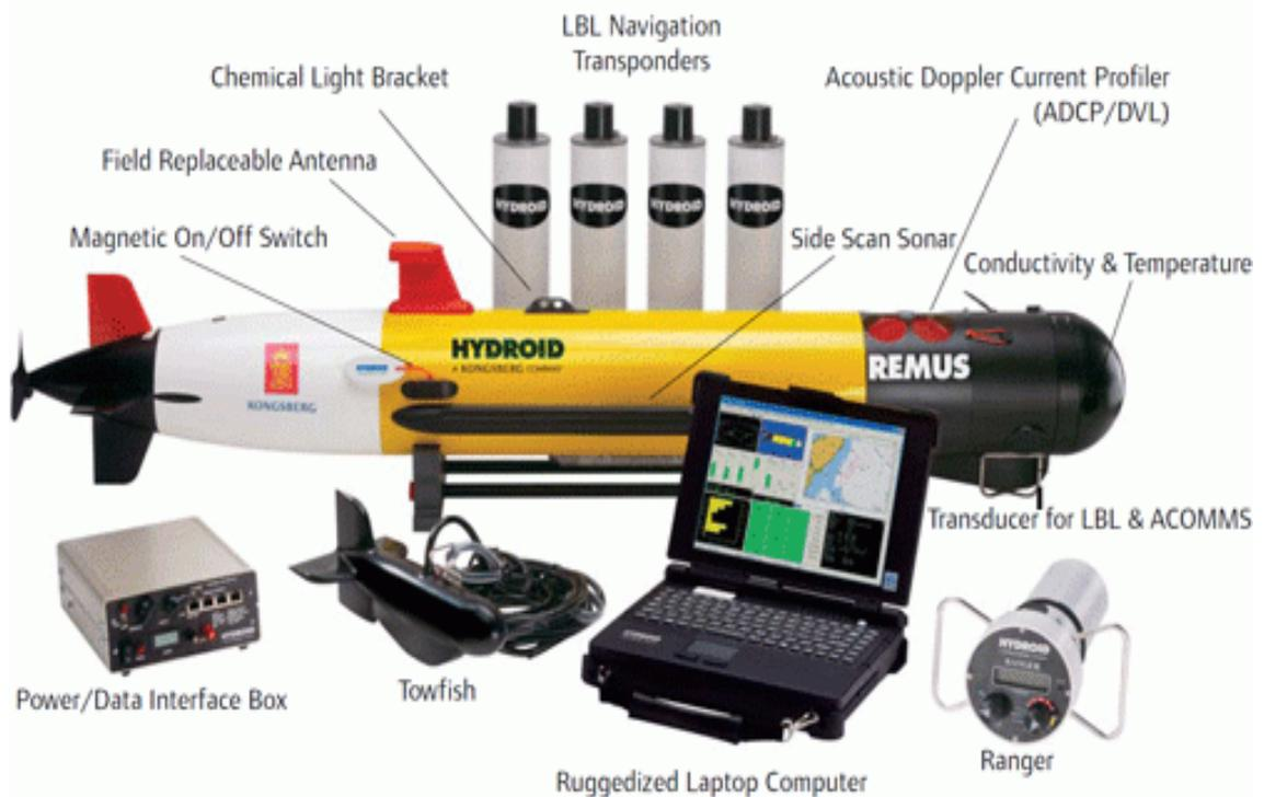
FIGURA 3 – VSA REMUS 100 com todos os seus sensores e acessórios oriundos da configuração padrão de fábrica.
