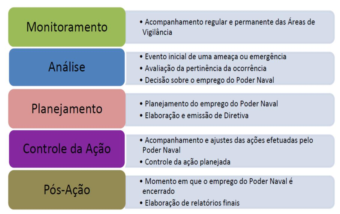
Figura 7 – Fases de uma operação no SisGAAz. Fonte: Consolidação da Arquitetura do Sistema, p4-120.
