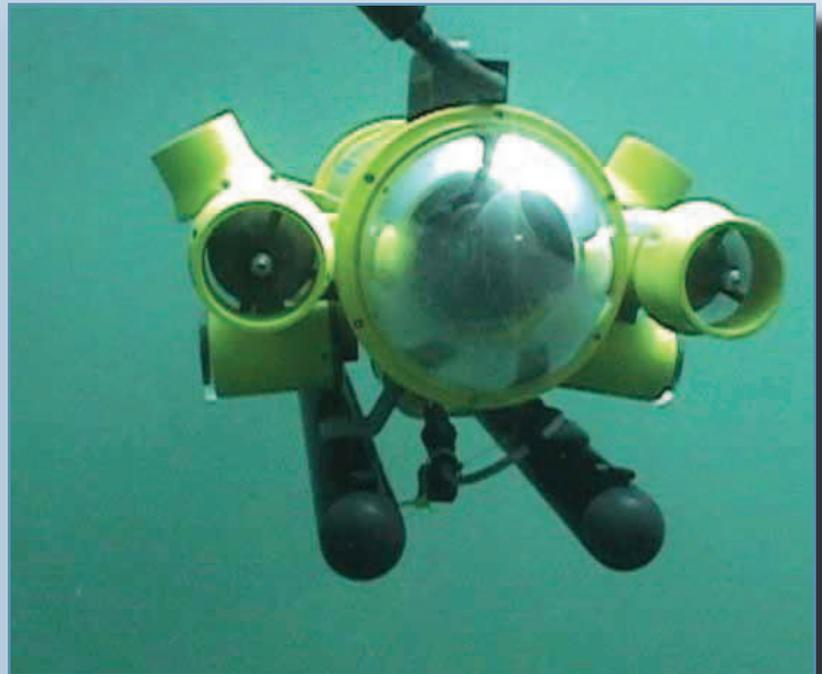
profundidade, posicionamento e temperatura da água. Além disto, possui um braço, com pinça articulada que permite a manipulação e a coleta de pequenos objetos e amostras no fundo.
