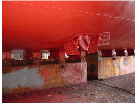
Foto mostrando a caixa de mar do navio Potengi, com as grades, por onde a água de lastro é captada do mar. (Foto: Pedro Santos).
