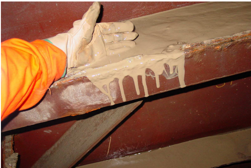
Foto mostrando o interior de um tanque de lastro vazio, com sedimentos, de água de lastro da baía de São Marcos, Maranhão, que ficam depositadas no fundo do tanque ou nas vigas de sustentação das anteparas dos tanques. (Fotos: Pedro Santos).
