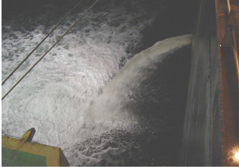
Foto mostrando a descarga de água de lastro pela válvula de costado no navio Potengi
