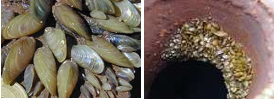
Figura 6: mexilhão dourado (esquerda), colônia de mexilhão em tubulação(direita)
