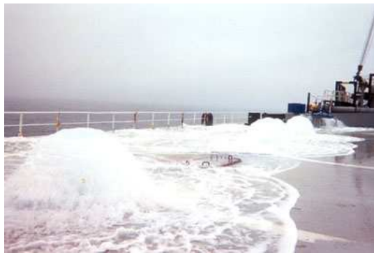
Figura 3: transbordamento de tanque de lastro
