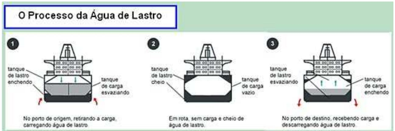
Imagem 3 – Esquema de procedimento para troca da água de lastro
