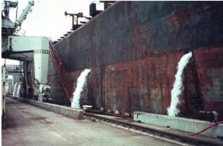
Imagem 1 – Descarga da Água de Lastro
