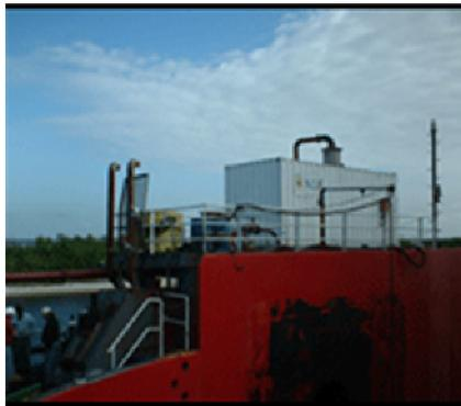
Esta empresa desenvolveu uma tecnologia de tratamento de água de lastro patenteada que provou ser segura, confiável e de um custo efetivo. O sistema induz uma condição de baixos níveis de oxigênio (hipóxica) nos tanques de lastro, utilizando o gás inerte.
