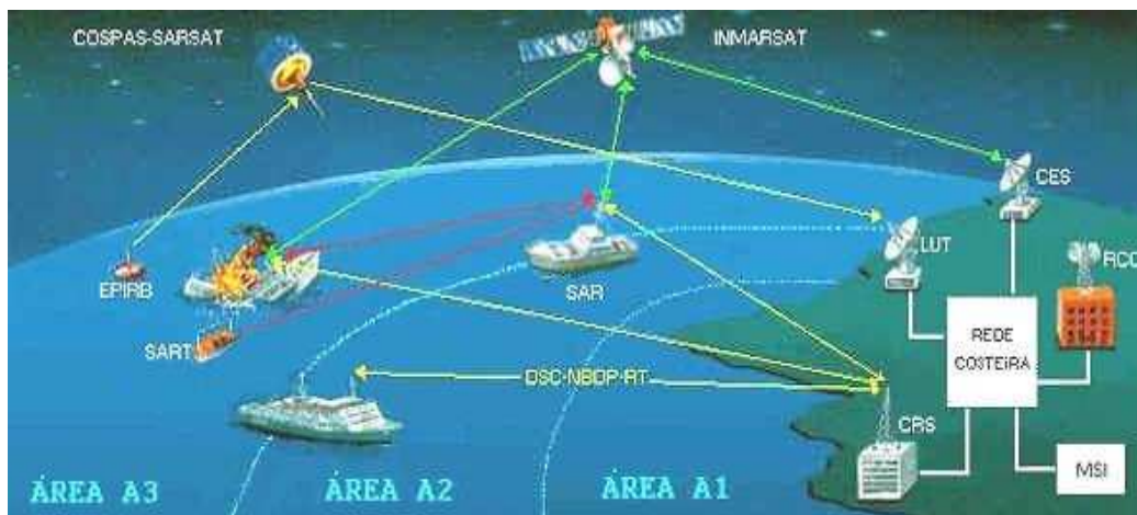
FIGURA Nº 2 - ESQUEMA DO FLUXO DE INFORMAÇÕES DO GMDSS
