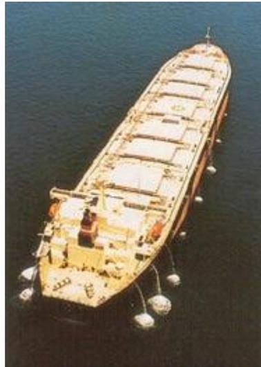
Imagem 10 – Deslastramento dos tanques de lastro no mar
