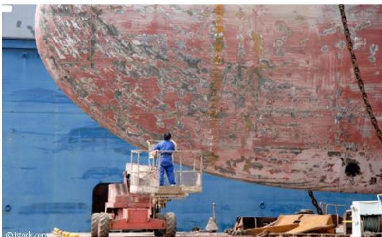
Figura 7- Casco com incrustações (Fonte :[www.webmagazine.lanxess.com.br](http://www.webmagazine.lanxess.com.br))
