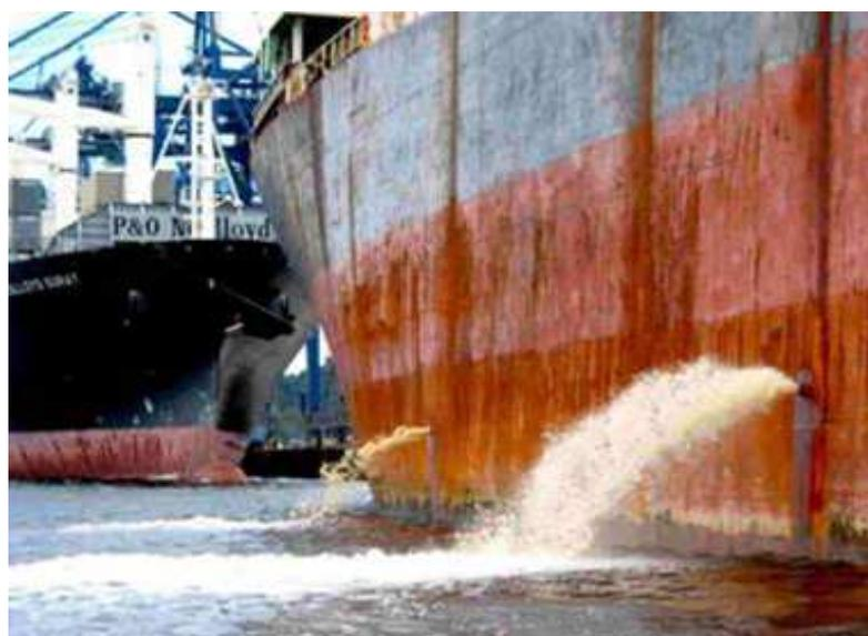
Figura 1. Navio descarregando água de lastro de seus tanques
