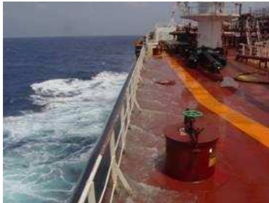
Figura 7- Navio utilizando o método do transbordamento
