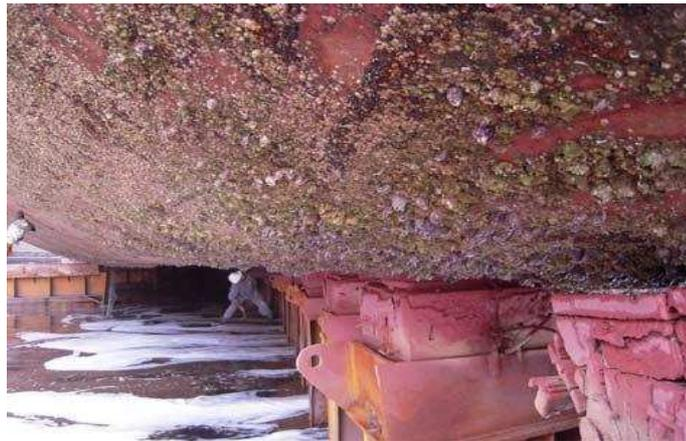
Figura 2. Casco com incrustação
