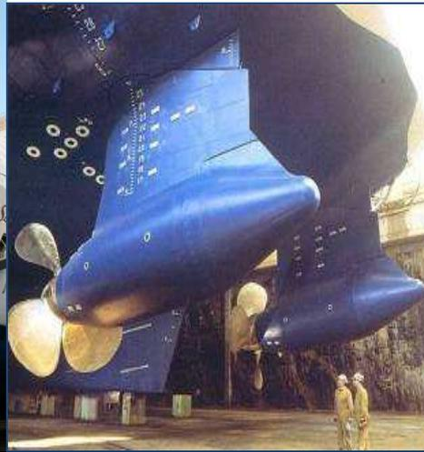
Figura 13 - *Azimuth Thruster*
