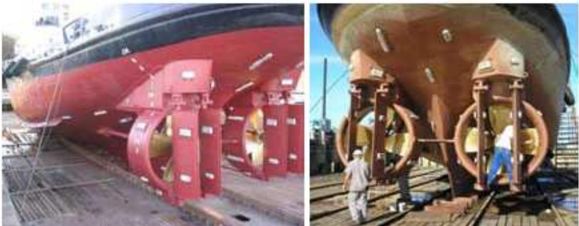
Figura 01: Rebocador com dois hélices fixos e direcionador de fluxo.
