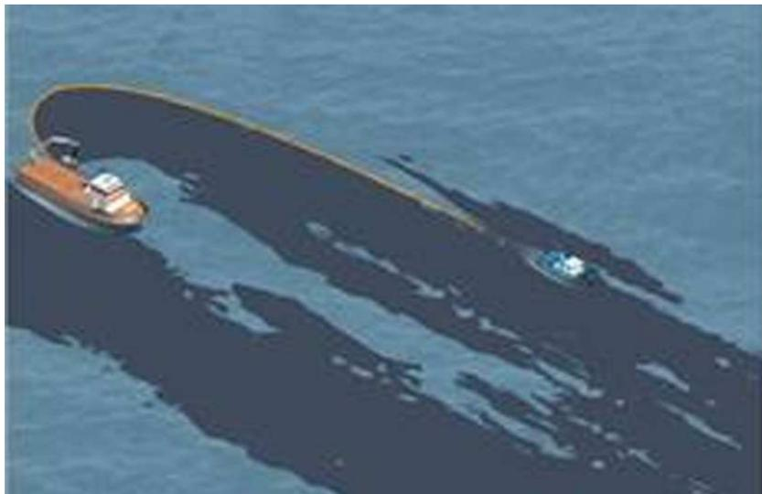
FIG-17 OSRV em operação conjunta com AHTS
