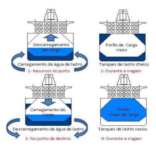
Figura 3 – Utilização da água de lastro. Fonte: ONG Água de Lastro Brasil – ALB.
