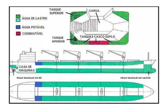
Figura 5 – Tanques de Lastro de Navios. Fonte: Departamento de Engenharia Naval e Oceânica da Escola Politécnica da Universidade de São Paulo.
