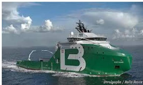
**Figura 7. Embarcação AHTS - *Anchor Handling Tug Supply***
