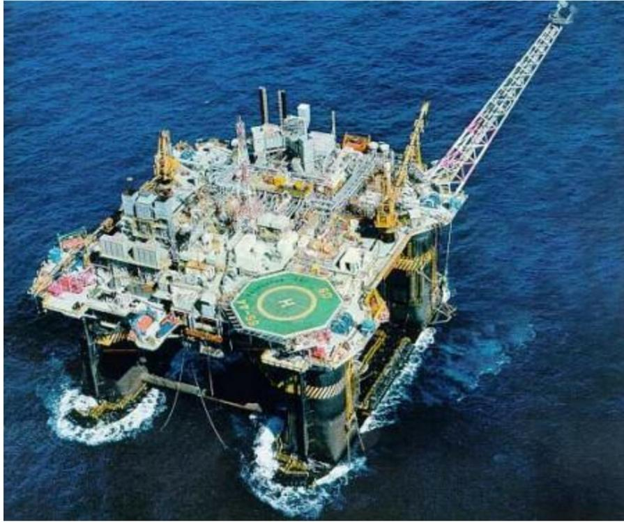
**Figura 4. Plataforma de perfuração semi-submersível**
