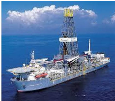
**Figura 3. Navio de perfuração – *Drillship* (Marinelog, 2006)**
