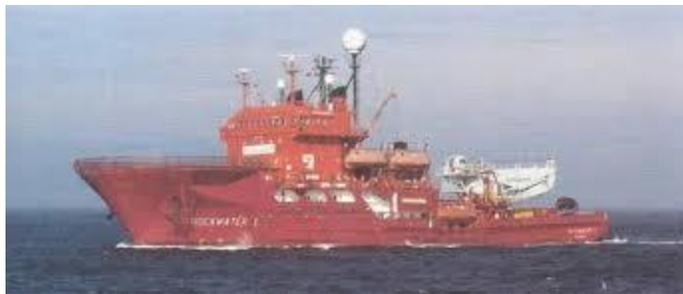
**Figura 10. Embarcação DSV - *Diver Support Vessel***
