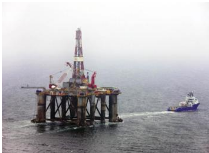
Figura 23 - AHTS rebocando uma plataforma
