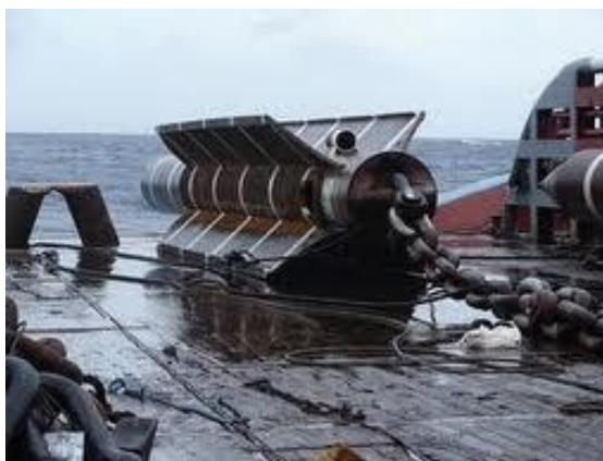
Figura 20 - Manuseio de uma âncora torpedo
