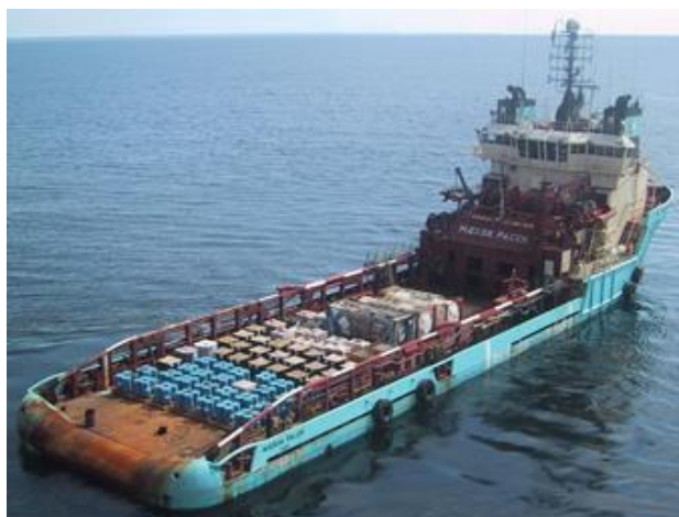
Figura 21 - AHTS exercendo a função de supply
