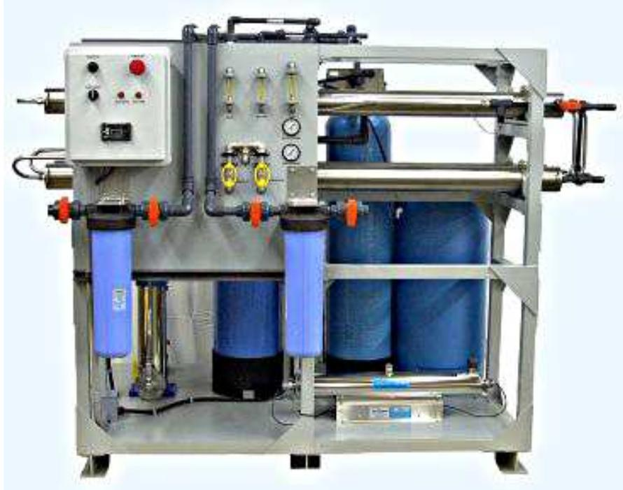
Figura 5 - Sistema típico de Osmose Reversa horizontal.
