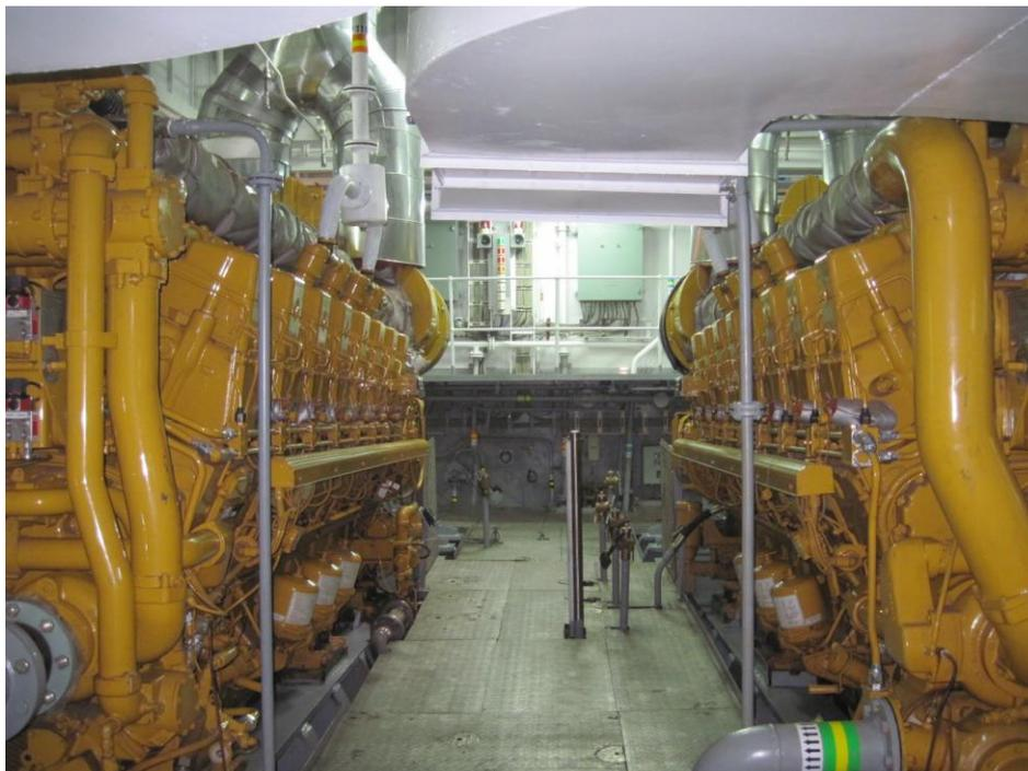
FIGURA 9 – Motores de Combustão Principais (MCP) Caterpillar, modelo C280-16
