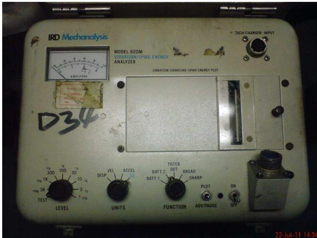
**Medidor de vibração Original das Fragatas Classe Greenhalgh – Obsoleto/Avariado – Mechanalysis IRD 820M**
