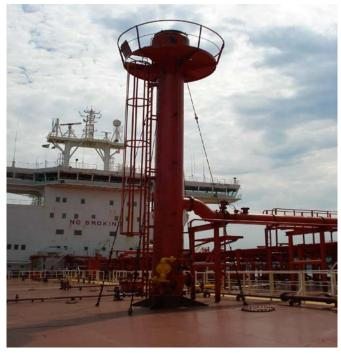
Figura 12: Poste de Ventilação (Vent Riser) Fonte: Manual VOC Navion Stavanger
