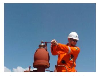
Figura 16: manutenção em uma válvula PV pela tripulação. Fonte: Manual de VOC do Navion Stavanger.
