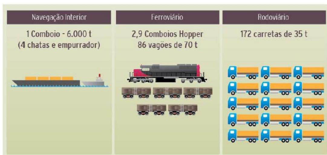
FIGURA 2 - Comparação entre as capacidades de carregamento dos modais
