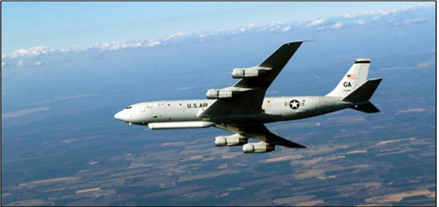
FIGURA 3 – E-8C Sistema Conjunto de Vigilância e Radar de Ataque de Alvos (E-8C Joint STARS)
