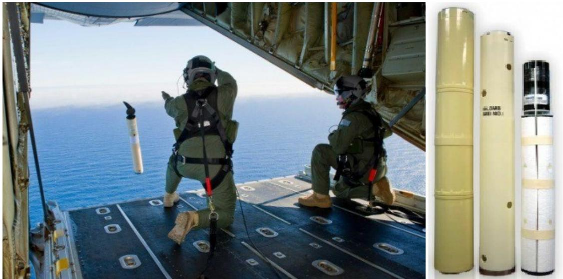
FIGURA 3 – SLDMB configuradas para lançamento por aeronave.
